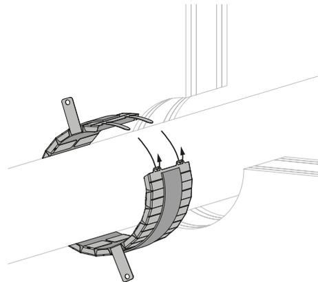
4. Pliez le manchon et montez-le autour du tuyau. Insérez les languettes de fermeture dans les ouvertures prévues. Repliez les languettes.
