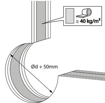
2. Prévoyez une ouverture de  $\text{Ød} + 27$  mm minimum et  $\text{Ød} + 50$  mm maximum pour diamètres de tuyau 32-75,  $\text{Ød} + 36$  mm et  $\text{Ød} + 50$  mm pour diamètres de tuyau 80-110,  $\text{Ød} + 40$  mm et  $\text{Ød} + 50$  mm pour diamètres de tuyau 125-160.
